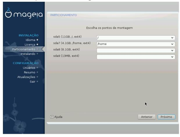
Aqui você vê as partições Linux que foram encontrados em seu computador. Se você não concorda com as sugestões do DrakX, você pode alterar os pontos de montagem.
